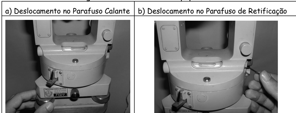
Figura 15 - Retificando o Equipamento
