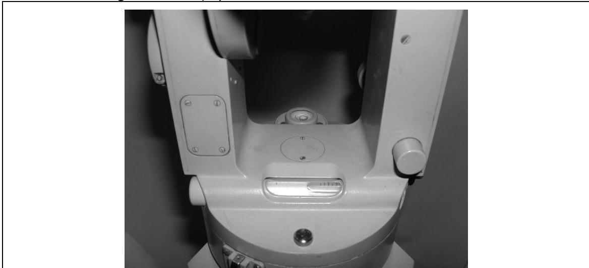
Figura 13 - Equipamento necessitando de Retificação
