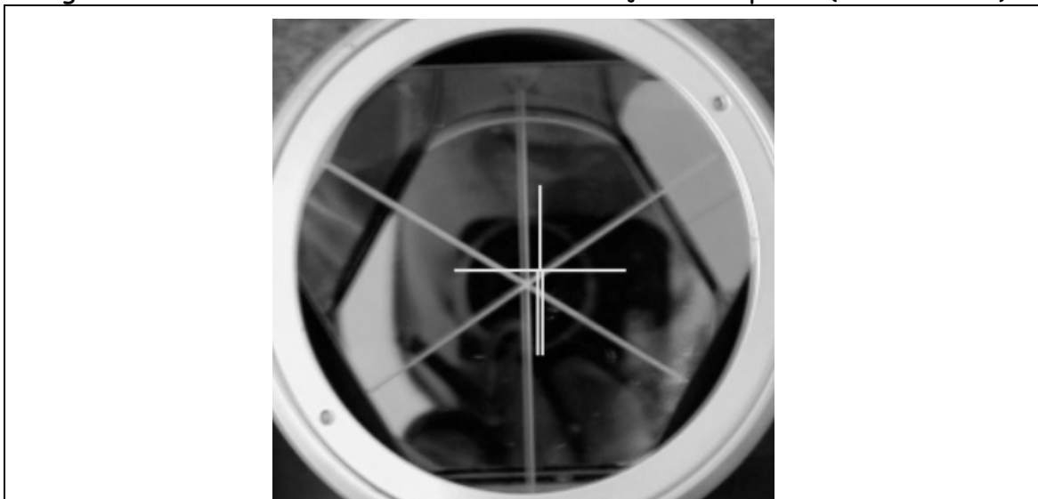
Figura 29 - Prisma refletor e retículo da estação sobreposto (erro do ATR)
