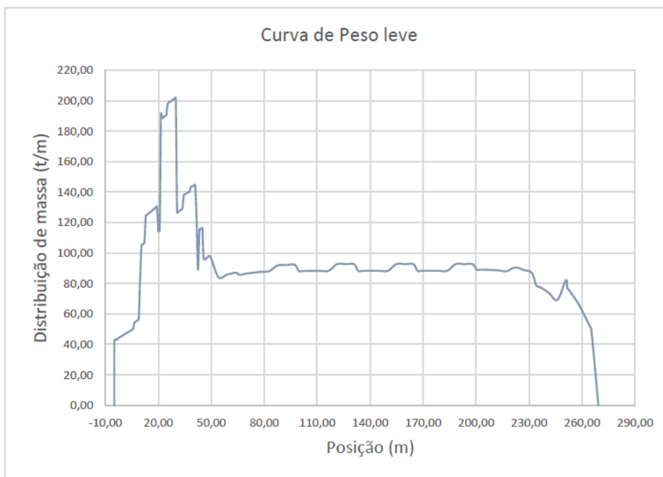
Figura 33. Exemplo de Curva de Peso.
