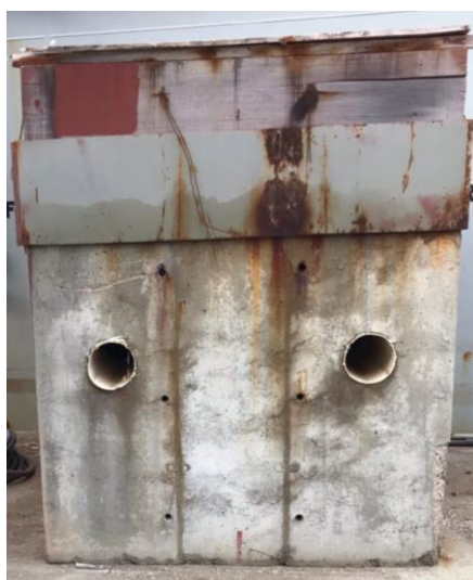
Figura 35. Modelo comum de picadeiro utilizado em estaleiros brasileiros.
