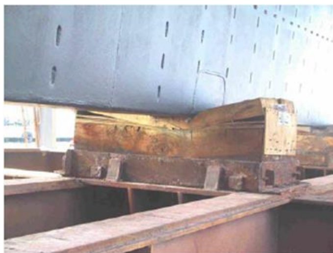
Figura 5. Esmagamento da madeira de contato em picadeiro.
