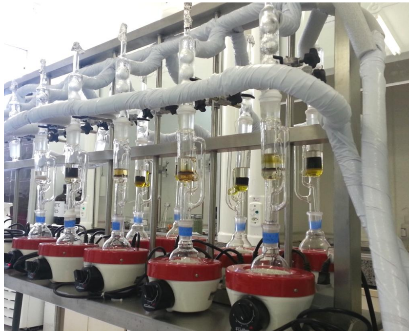
Figura 5 – Extração de um lote de amostras de sedimento do estuário do Capibaribe em conjuntos Soxhlet.
